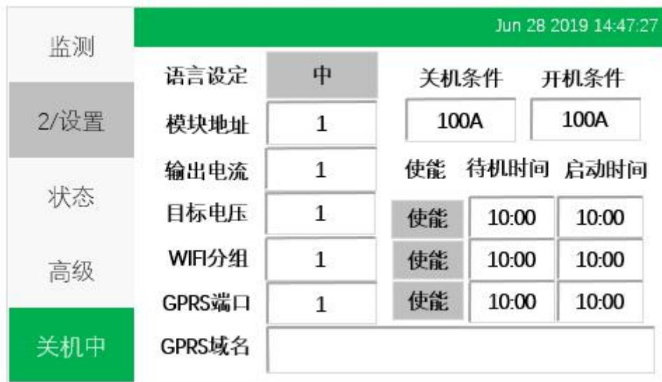
图5-10 设置界面2-通讯及节能参数设置
