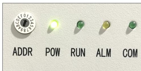
图 1-18 拨码开关及状态指示灯示意图
